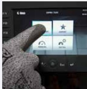
• **Ergonomie** : L'utilisation de l'écran tactile est compatible avec le port de gants.
