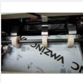
• Le **système d'embrayage** permet de maintenir le métal et évite ainsi de devoir ré-engager la bobine de métal.
