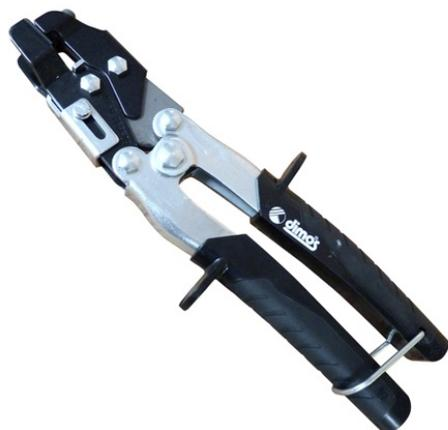
La pince à poinçonner permet de réaliser un trou oblong afin d'éviter le déchirement du zinc ou de réaliser une ventilation.
