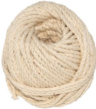
Les cordes sont utilisés en charpente pour la préparation du travail de couverture et le traçage du pureau.
