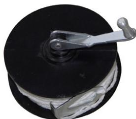
Les cordeaux sont utilisés en charpente pour la préparation du travail de couverture et le traçage du pureau.
