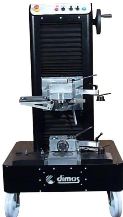
La cintreuse est une machine qui permet de cintrer des bacs pour toiture et bardage en joint debout à partir de feuilles métalliques.
