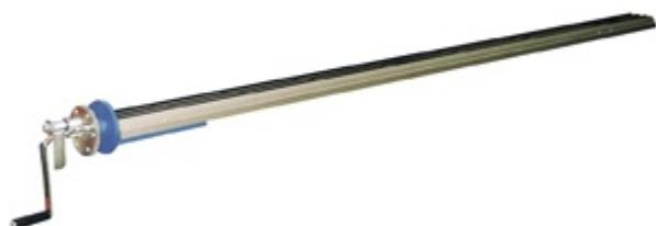
Les baguetteuses permettent d'ourler des feuilles de métal sur des diamètres de 13 à 25mm.
