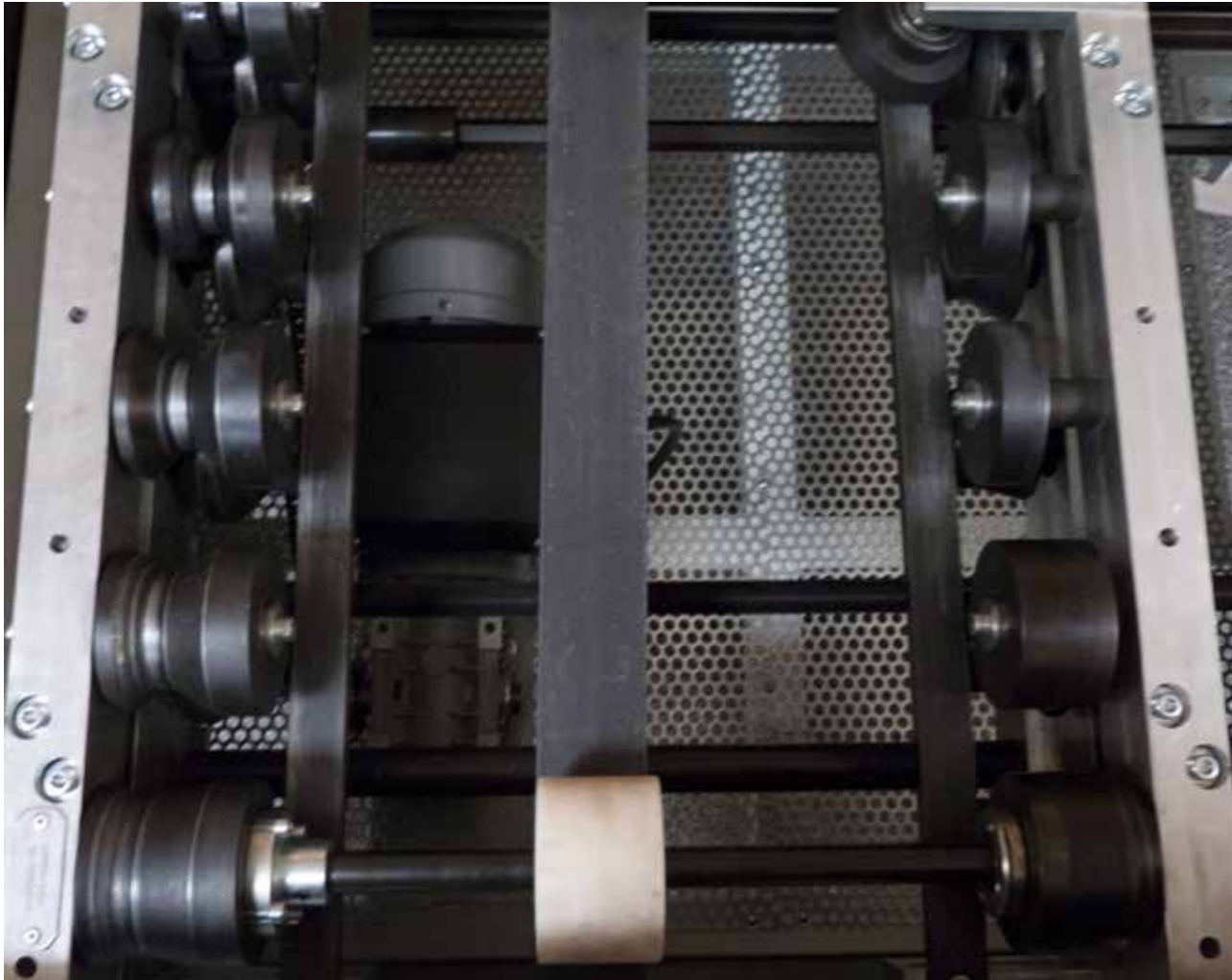
01 Support central : Maintien des bacs de grandes largeurs et des bacs gironnés. Train de profilage adaptable à tous types de métaux. Fonds de bacs de 180 mm en une seule passe (idéal pour le bardage).
